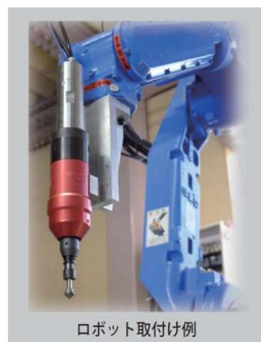
ロボット取付け例
