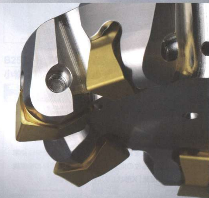
曲面形状のインサート保持部でボディ損傷を軽減
