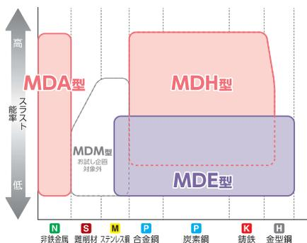
多様な被削材・加工条件での使用にオススメ >> **MDE型**
