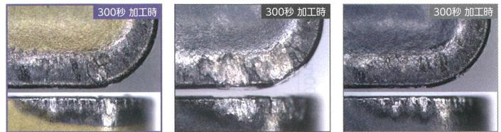
被削材: FCD450 断続切削 インサート: CNMG120408 切削条件: vc=450m/min f=0.3mm/rev ap=1.5mm Wet
