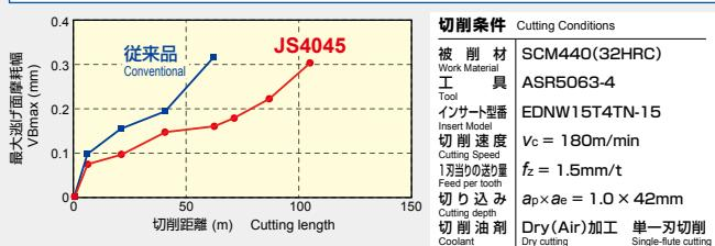
P20(32HRC) の切削試験結果 Wear graph after cutting P20 (32HRC)
