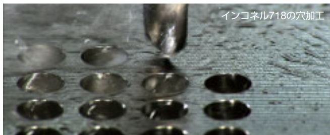
切れ味と強度を両立した刃先形状によりチップングを抑制
