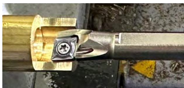
ディンプルバー 最小加工径 10mm
