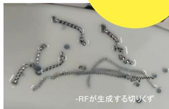
結果: この被削材における-RFブレードの切りくず排出性は、-RMブレードよりもはるかに優れている。良好な切りくず処理により加工安定性が向上。
