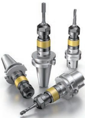
マイクロフローティングにより、タップの送りとピッチの微小なズレを正確に補正し、切削抵抗の増大や極めて高いスラスト荷重を抑制。
