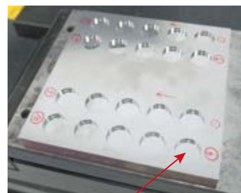
加工形状 Machining shape \phi 8.8 \times 深さ Depth 1.5mm
