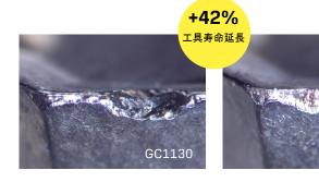
結果:材種GC1230に変更することで、工具寿命が42%向上しました。 さらに、切削条件を上げることで、GC1130と同じ工具寿命を維持しなが らエネルギー消費が削減できました。
