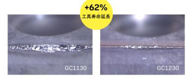
結果:材種GC1230に変更することで、工具寿命が62%延長しました。 さらに、安全性を損なうことなく、GC1130と同じ工具寿命を維持しな がら、切削条件を上げてエネルギー消費を削減できます。
