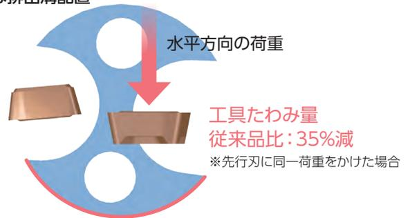
肉厚の方向を制御してたわみ量を抑制
