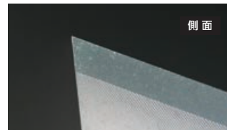
ランドがなく刃先先端からすくい面を形成 食付きが向上し、高精度・安定加工が可能 (~ \phi 12 )
