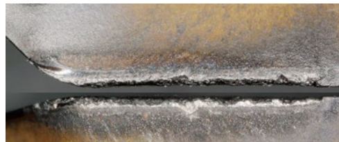
切削長さ3.6mで剥離チップングが発生
