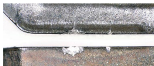
切削長さ6mで熱亀裂からチッピング
