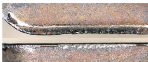
摩耗が進行し母材が露出
