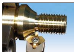
加工深さ4mmの溝入れ加工
