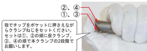
指でチップをポケットに押さえながらクランプねじをセットください。セットは①、②の順に仮クランプ、③、④の順で本クランプの2段階をお願いします。
