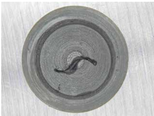
ドリルなどの切りくずが残る
